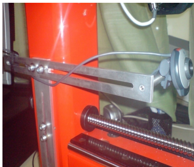
Slika 2: Stojalo za kamero in kamera na rezkalnem stroju LAKOS 150 G
