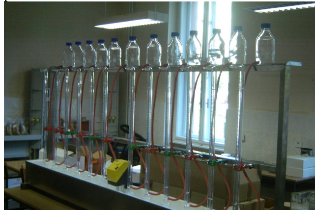
Slika 1: Laboratorijsko postrojenje za pridobivanje bioplina
