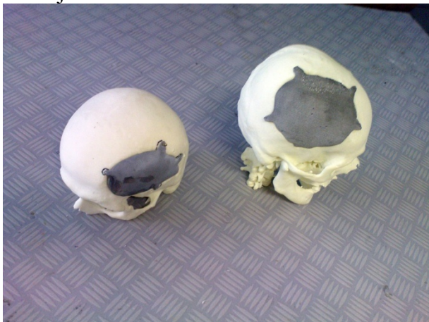
Slika 2: Lobanjska vsadka. Levi je izdelan s postopkom SLM, desni pa s postopkom EBM.
